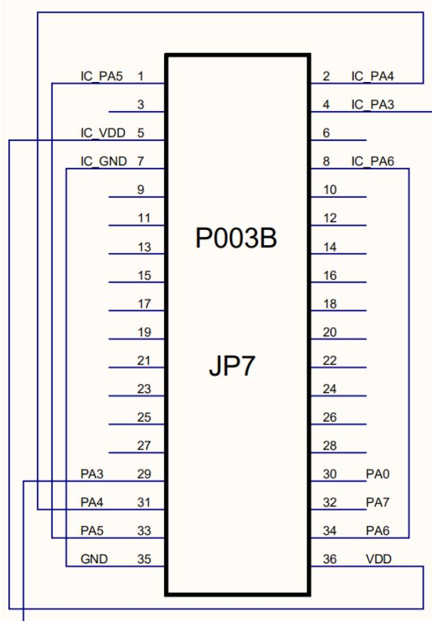
图 23: 使用 P003B 时, PMS161-S08B JP7 跳线原理图
