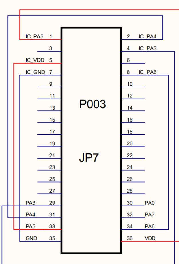
图 21: 使用 P003 时, PMS161-S08B JP7 跳线原理图
