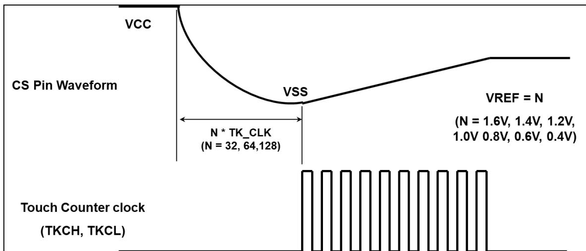
图 18: 触摸转换的时序图
