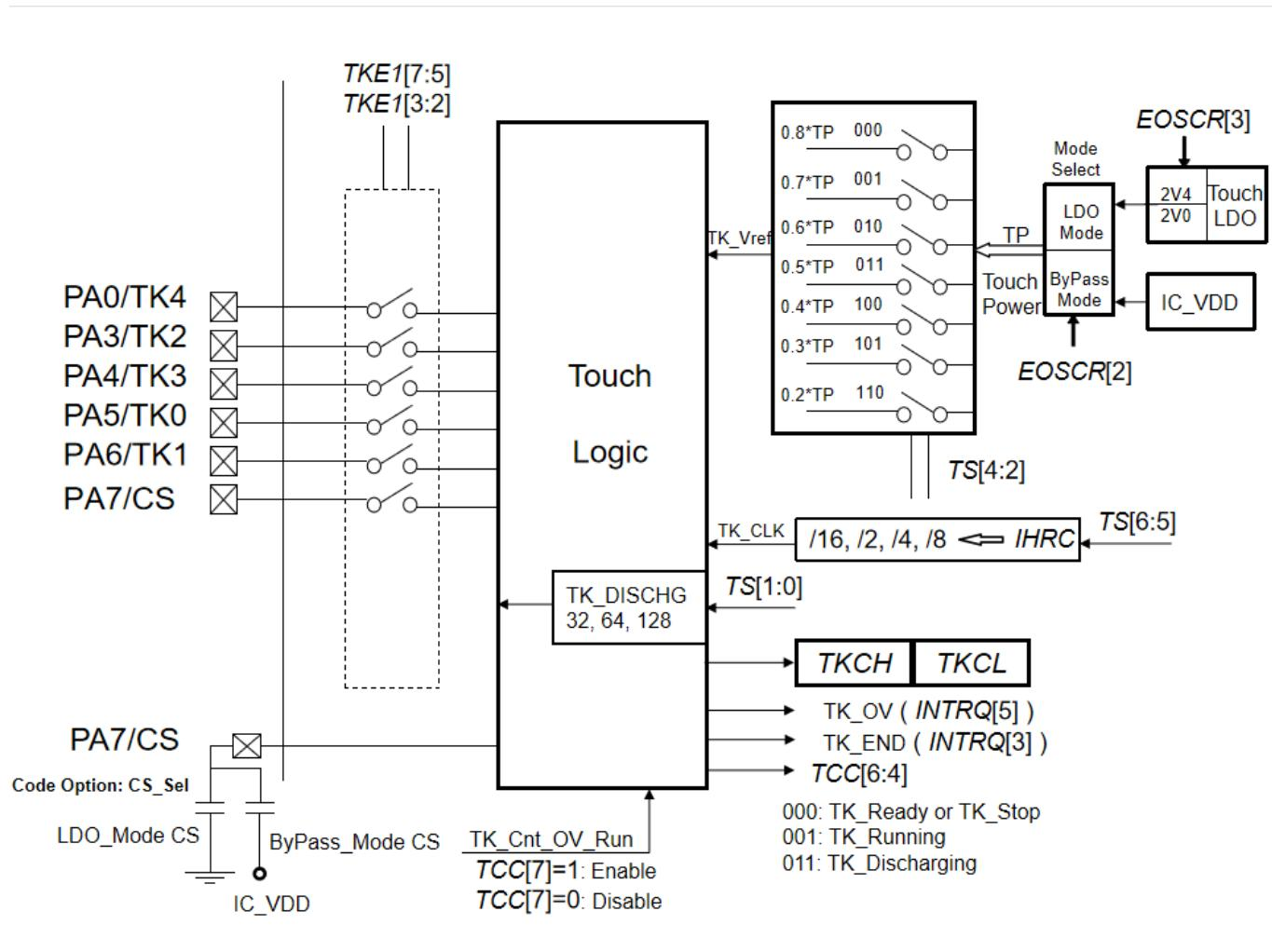
图 17：触摸检测电路的功能方框图
