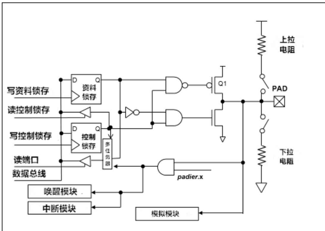
图 12: IO 引脚缓冲区硬件图
