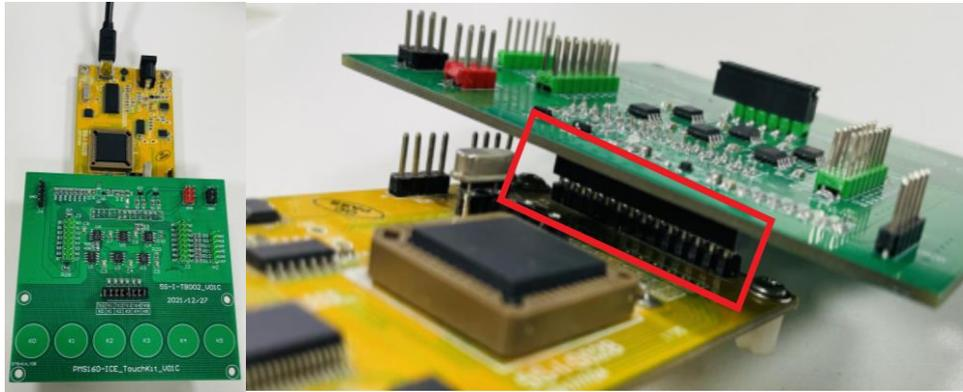
图 30: PMS152E 仿真工具连接示意图
