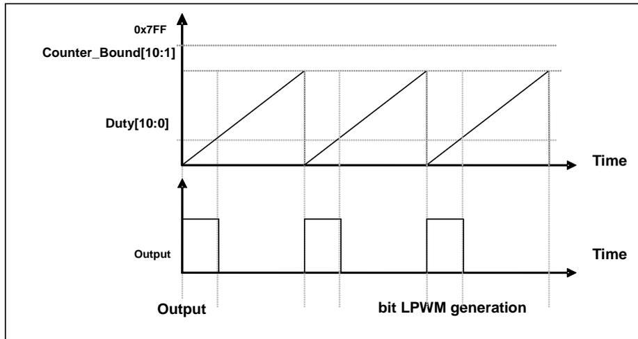
图 19: 11 位 LPWM 生成器输出时序图
