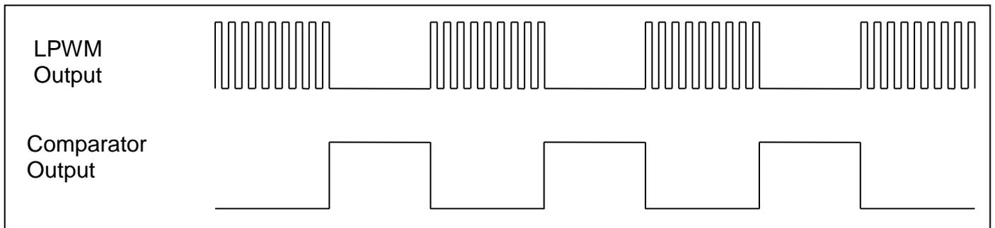
图 20: 比较器控制 LPWM 波形的输出
