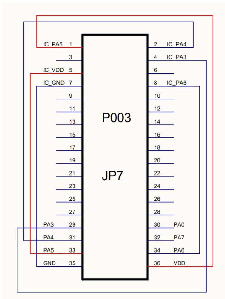
图 27：使用 P003 时，PMS152E-S08B JP7 跳线原理图
