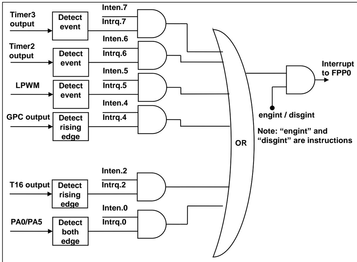
图 11: 中断控制器硬件框图
