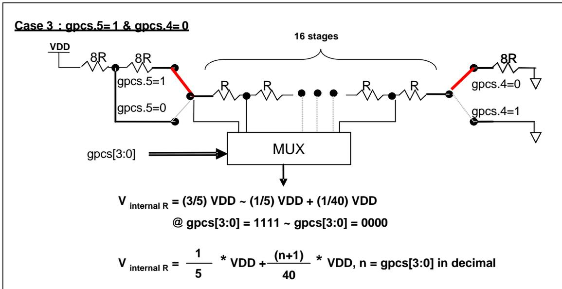
图 7:  $V_{\text{internal R}}$  硬件接法 (gpcs.5=1 & gpcs.4=0)
