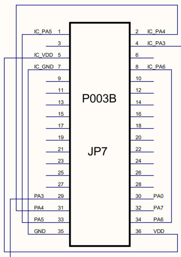
图 29：使用 P003B 时，PMS152E-S08B JP7 跳线原理图
