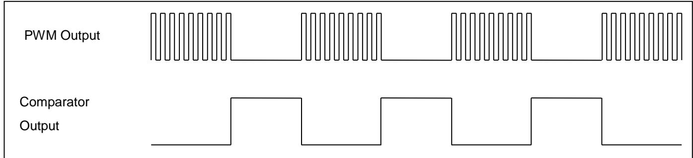
图 13: 比较器控制 PWM 输出
