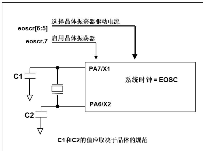
图 2: 晶体振荡器使用接法
