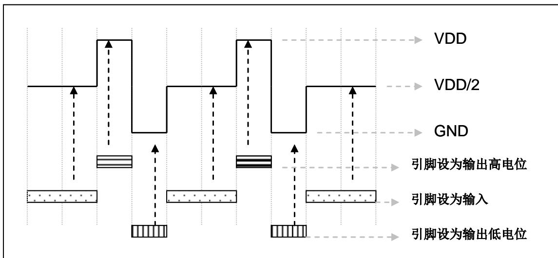
图 9：使用 VDD/2 LCD 偏置电压产生器
