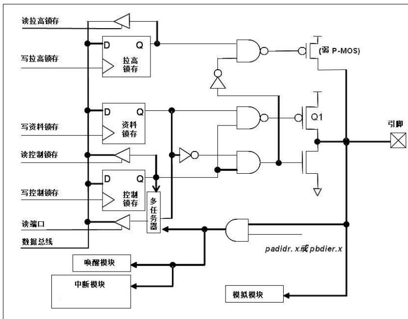
图 19: IO 引脚缓冲区硬件图
