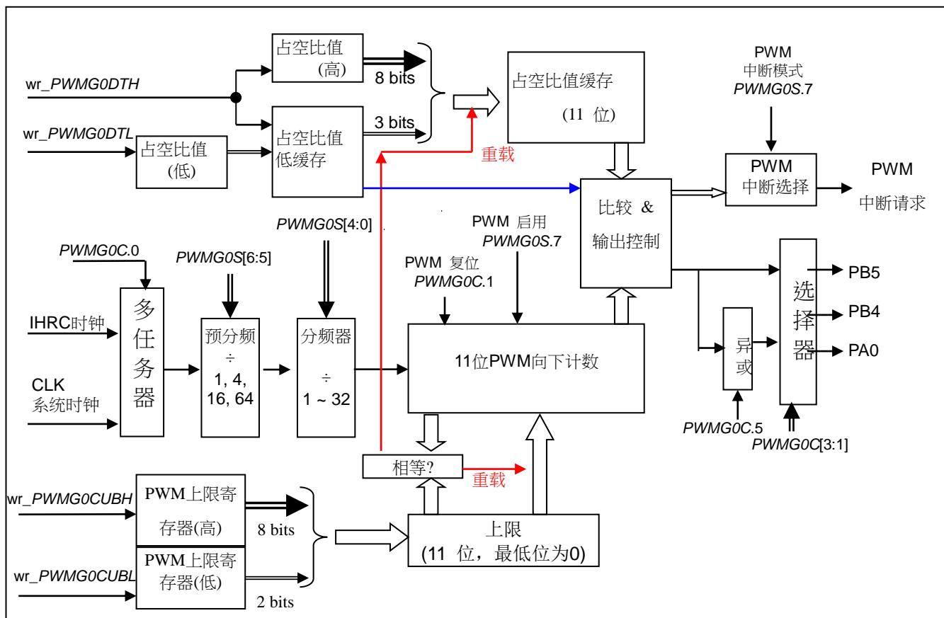
图 15: 11 位 PWM 生成器硬件框图
