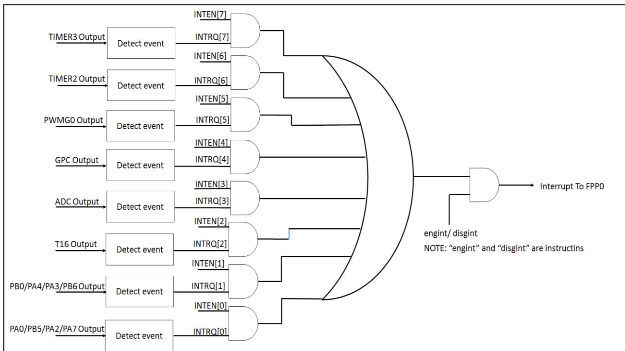
图 18: 中断控制器硬件框图
