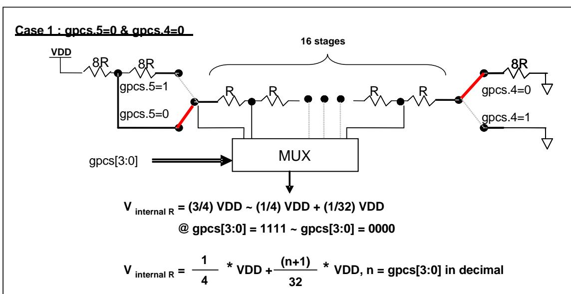
图 5:  $V_{internal\ R}$  硬件接法(gpcs.5=0 & gpcs.4=0)
