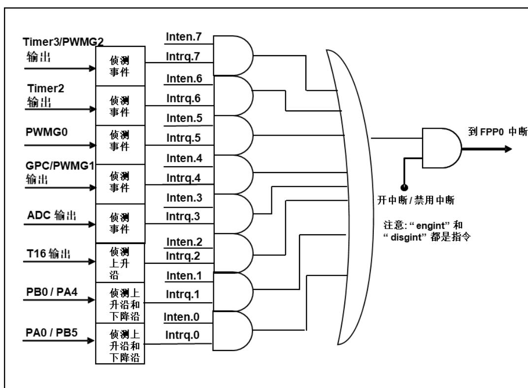
图 18：中断控制器硬件框图
