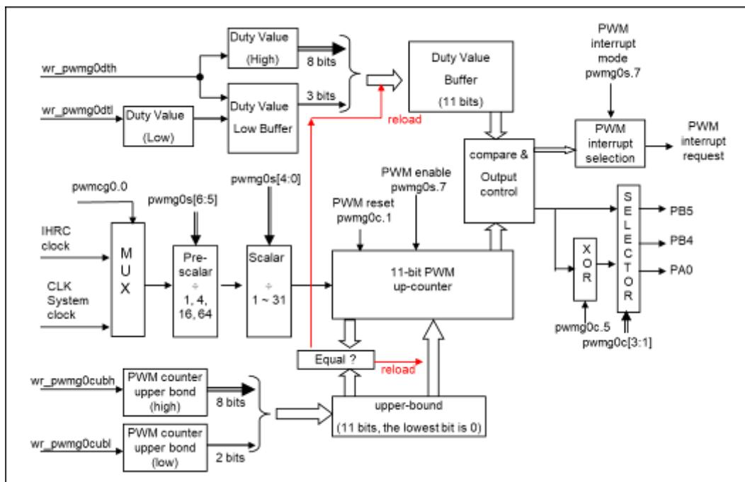
图 14: 11 位 PWM 生成器硬件框图
