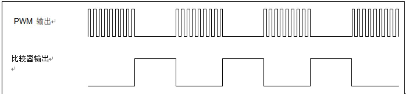
图 12：比较器控制 PWM 输出
