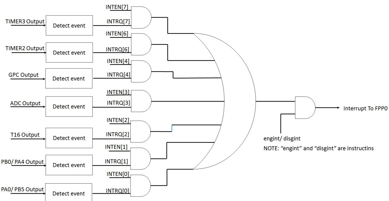
图 16: 中断控制器硬件框图
