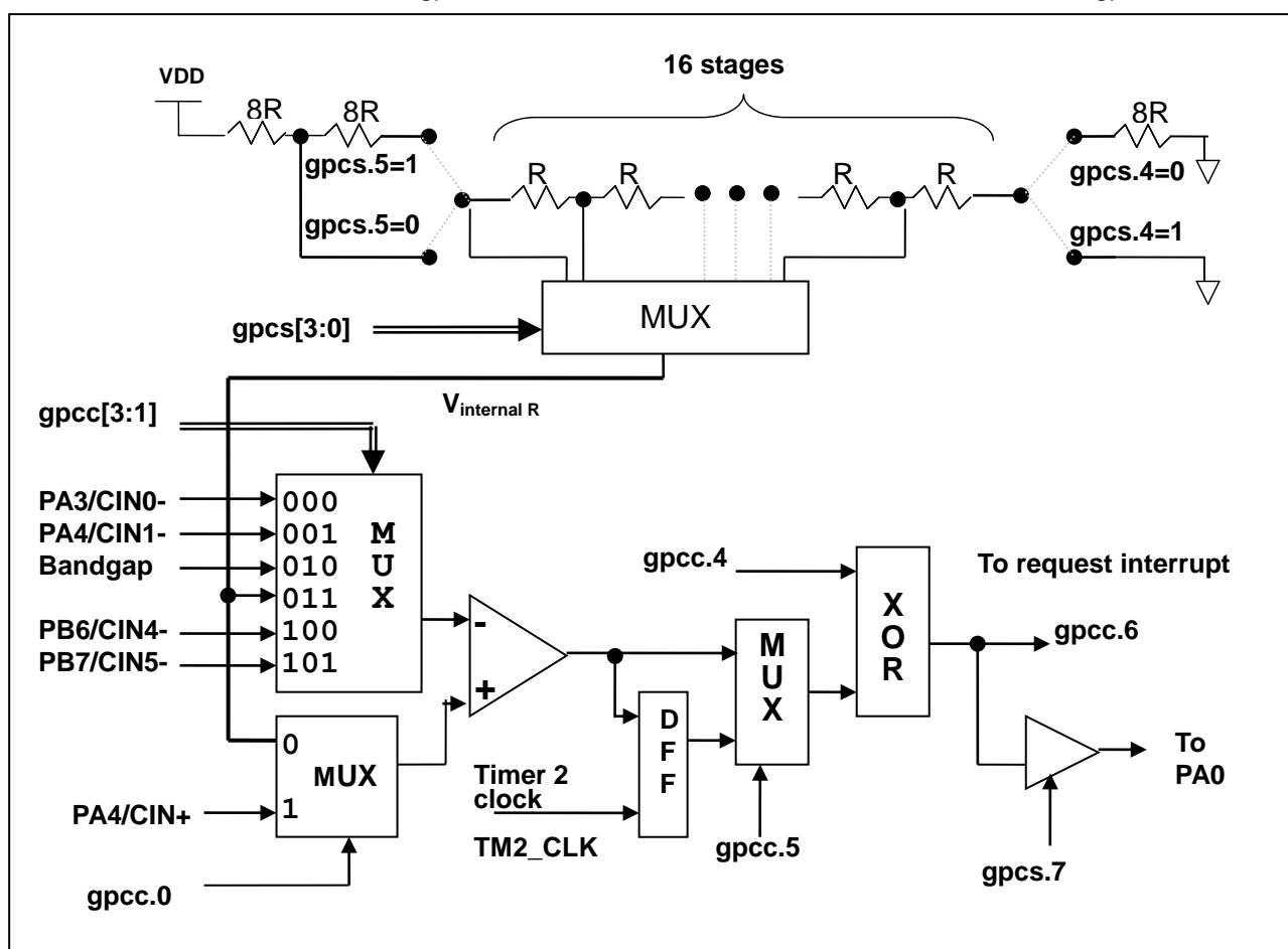
图 4: 比较器硬件原理框图
