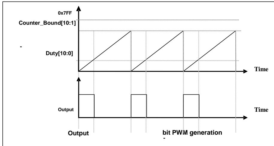
图 14: 11 位 PWM 生成器输出时序图
