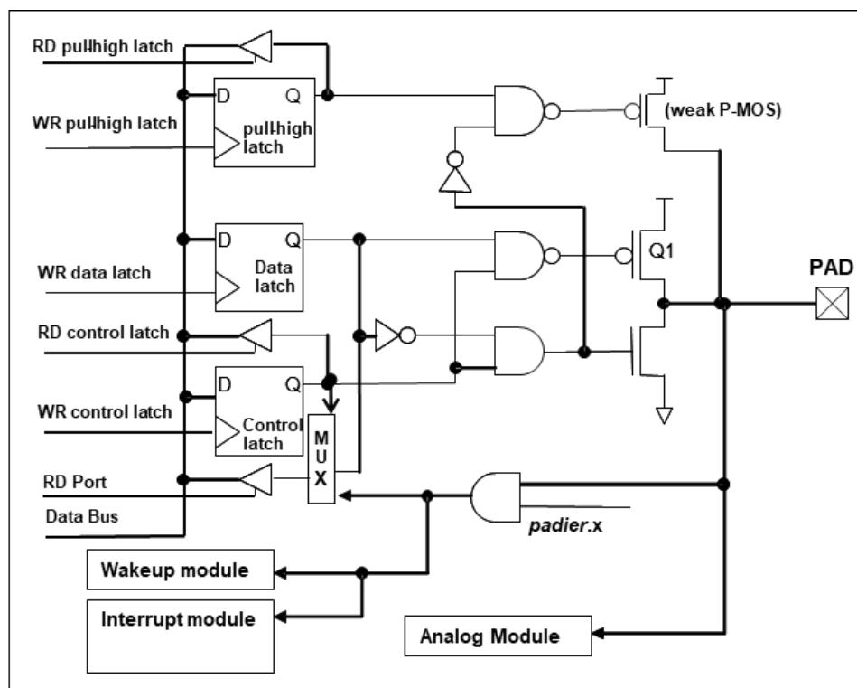
图 19: IO 引脚缓冲区硬件图
