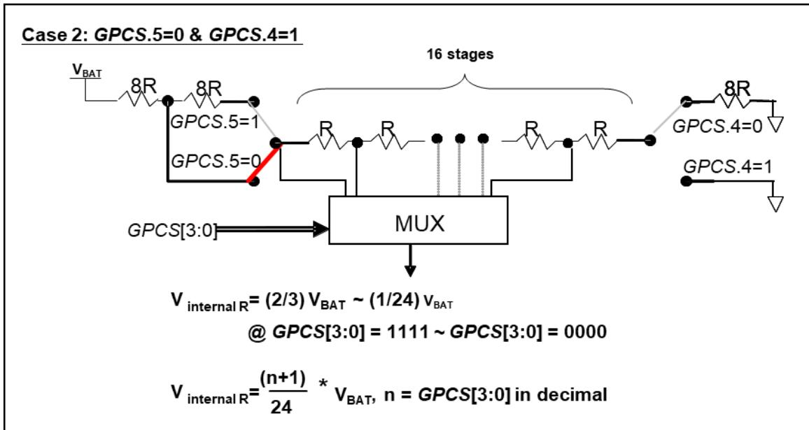
图 5:  $V_{internal\ R}$  硬件接法 (gpcs.5=0 & gpcs.4=1)
