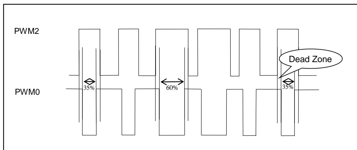
图 16：互补死区的 PWM 波形
