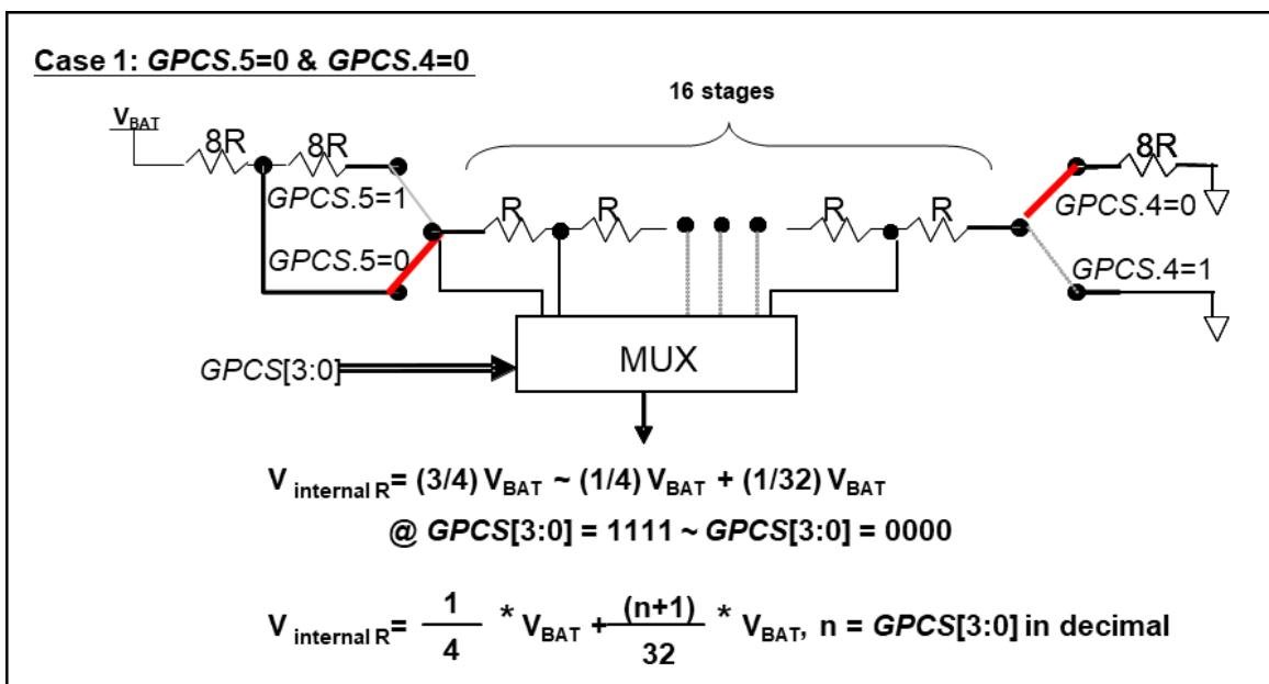
图 4:  $V_{internal\ R}$  硬件接法 (gpcs.5=0 & gpcs.4=0)
