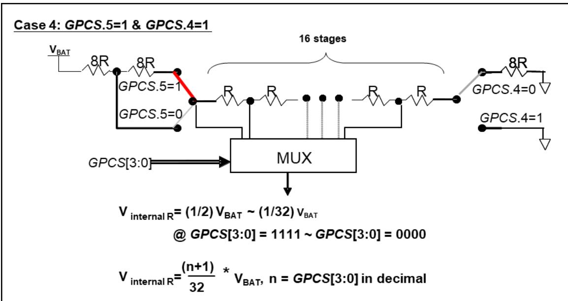
图 7:  $V_{internal\ R}$  硬件接法 ( $gpcos.5=1$  &  $gpcos.4=1$ )
