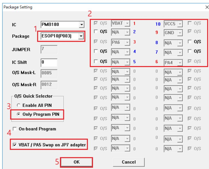
图 22: PMB180-ESOP10 在 P003 转档配置
