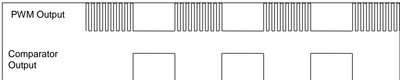
图 11: 比较器控制 PWM 波形的输出
