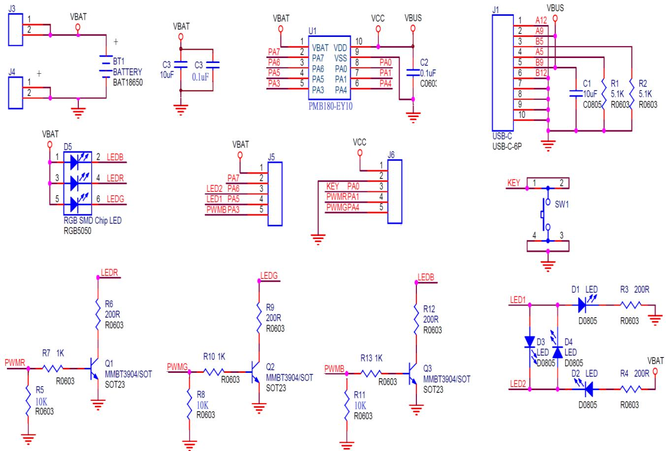
图 26: 带锂离子充电灯光控制原理图
