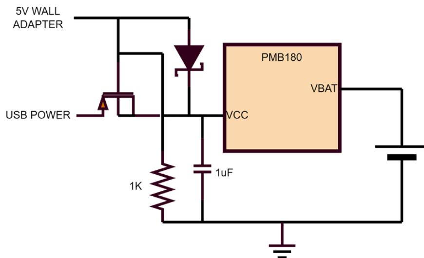
图 25：USB/墙壁适配器电源锂离子充电器
