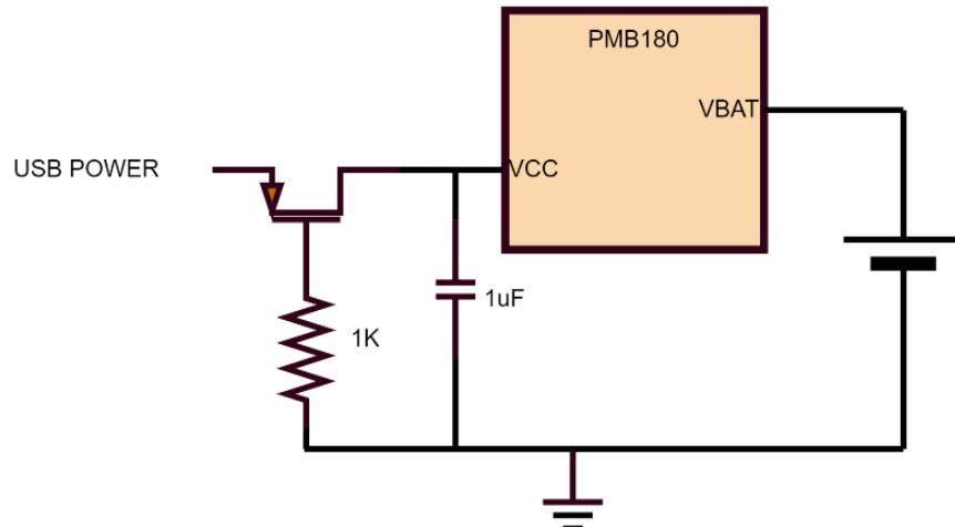
图 24：带反极性输入保护的基本锂离子充电器
