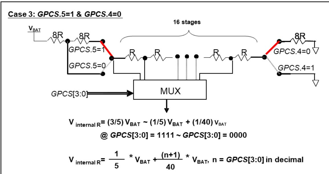
图 6:  $V_{internal\ R}$  硬件接法 ( $gpcos.5=1$  &  $gpcos.4=0$ )
