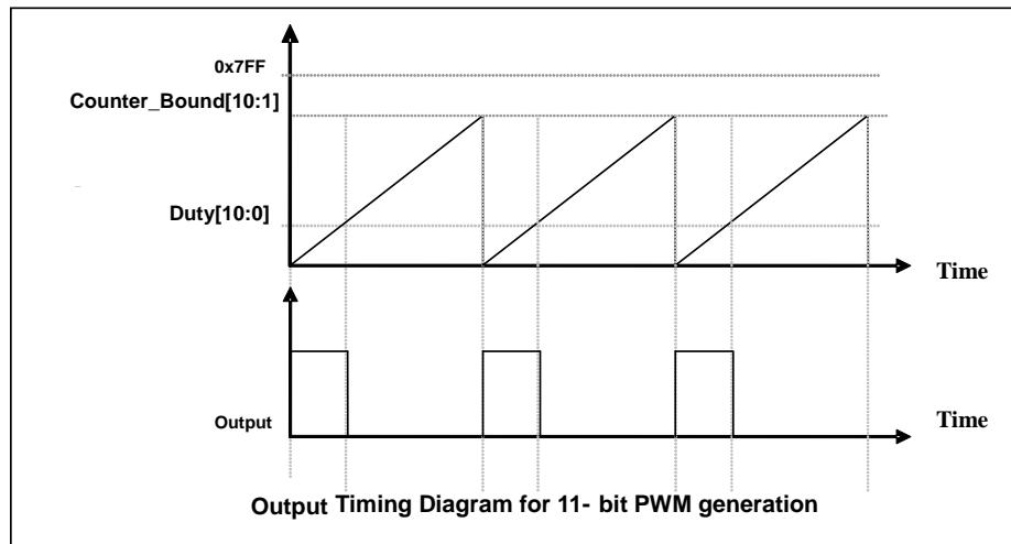
图 15: 11 位 PWM 生成器输出时序图
