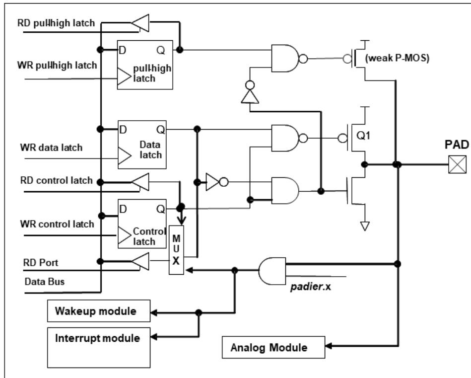
图 20：IO 引脚缓冲区硬件图
