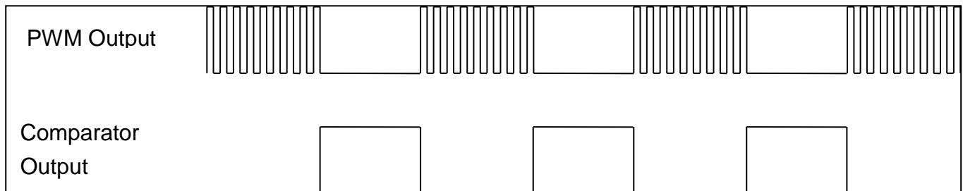
图 12: 比较器可控制 PWM 波形的输出波形
