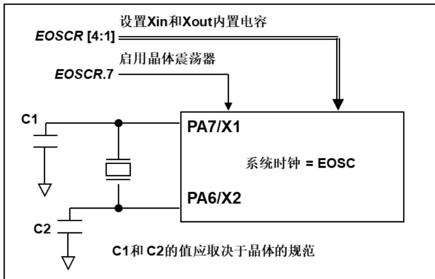
图 2: 晶体振荡器的硬件连接图
