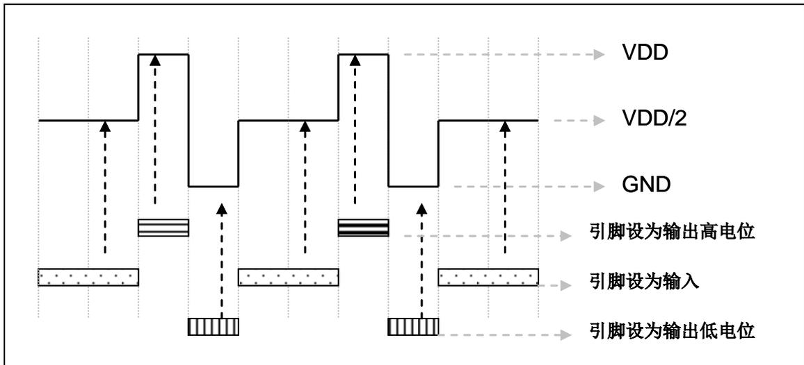
图 9：使用 VDD/2 LCD bias 电压生成器
