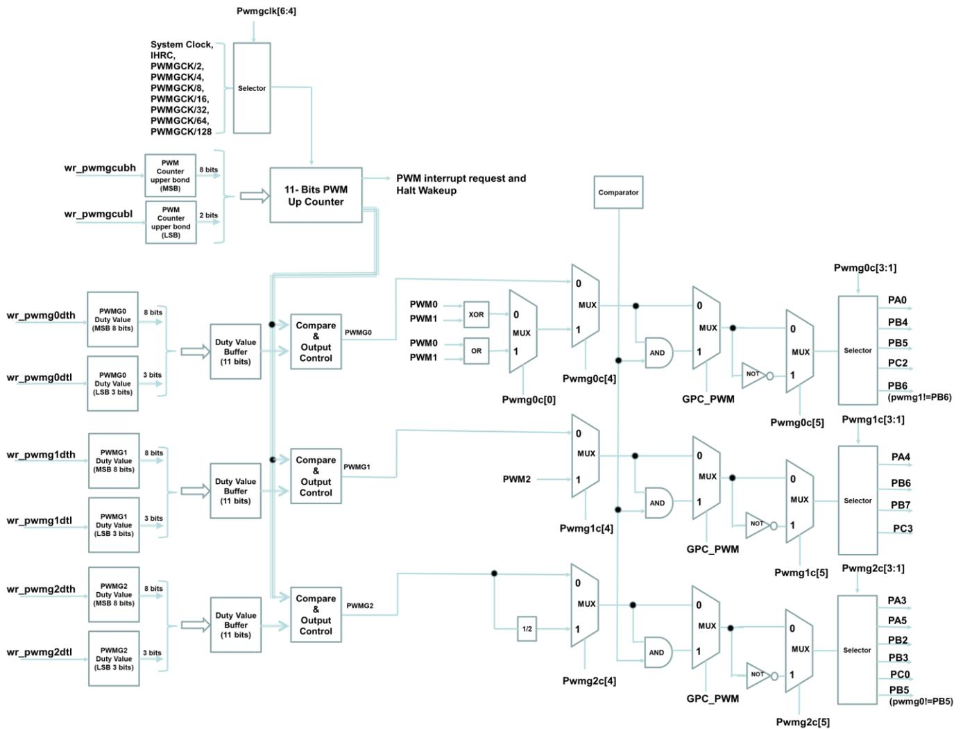
图 15: 整组 SuLED 三路 11 位 PWM 生成器硬件框图
