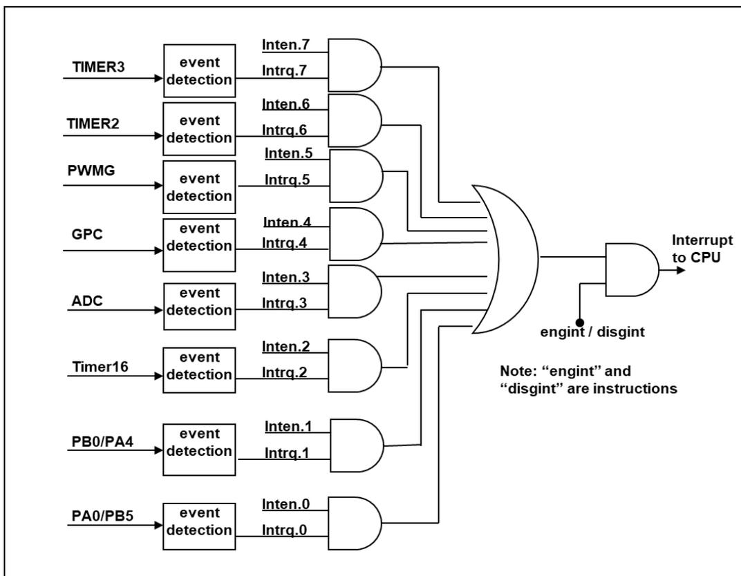
图 20: 中断控制器硬件框图
