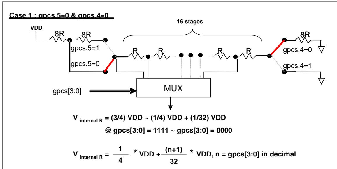
图 5:  $V_{\text{internal R}}$  硬件接法( $gpc\text{s}.5=0$  &  $gpc\text{s}.4=0$ )
