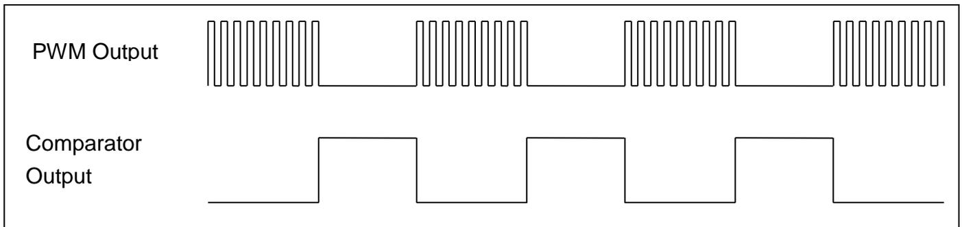
图 13: 比较器控制 PWM 波形的输出
