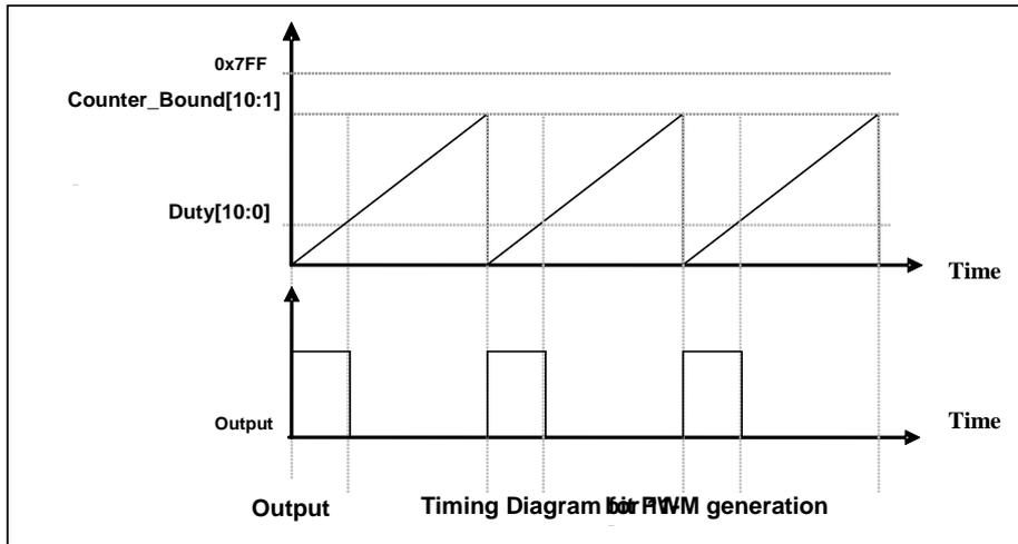
图 16: 11 位 PWM 生成器输出时序图
