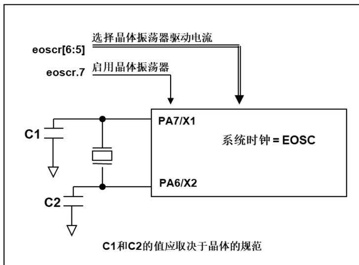
图 2: 晶体振荡器的的硬件连接
