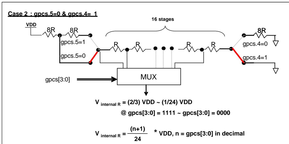
图 6:  $V_{\text{internal R}}$  硬件接法( $gpc\text{s}.5=0$  &  $gpc\text{s}.4=1$ )
