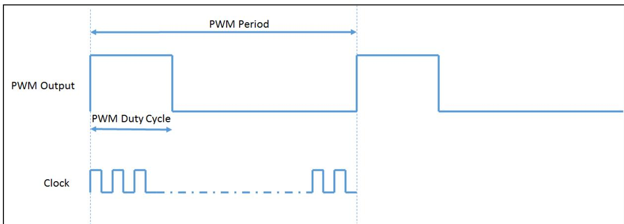
图 14: PWM 输出波形
