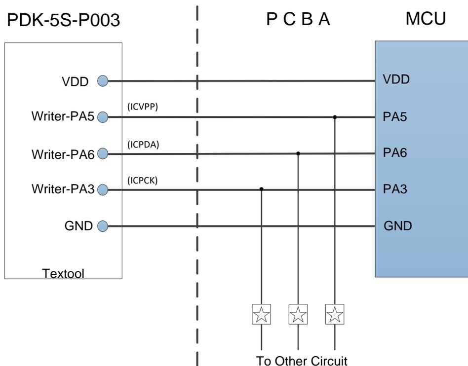
上图为 PFS123 在板烧录时接线示意图。图中的 ☆ 为电阻或电容，用于隔离烧录引线和其他电路。电阻应 $\geq 10K\Omega$ ，电容应 $\leq 220pF$ 。
