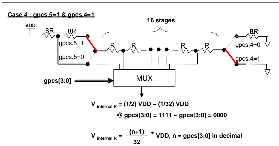
图 8:  $V_{internal\ R}$  硬件接法( $gpcs.5=1$  &  $gpcs.4=1$ )
