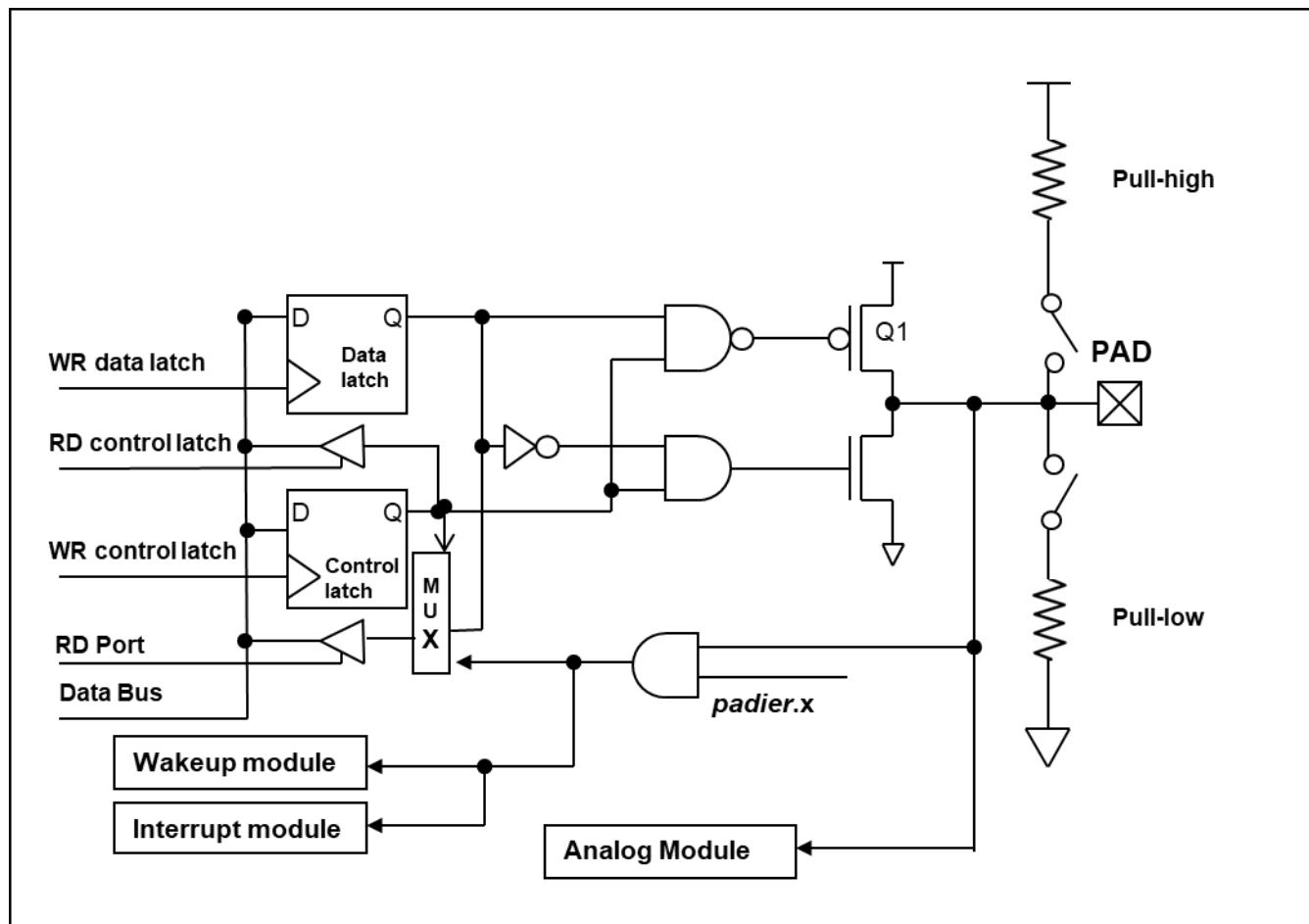
图 18: IO 引脚缓冲区硬件图
