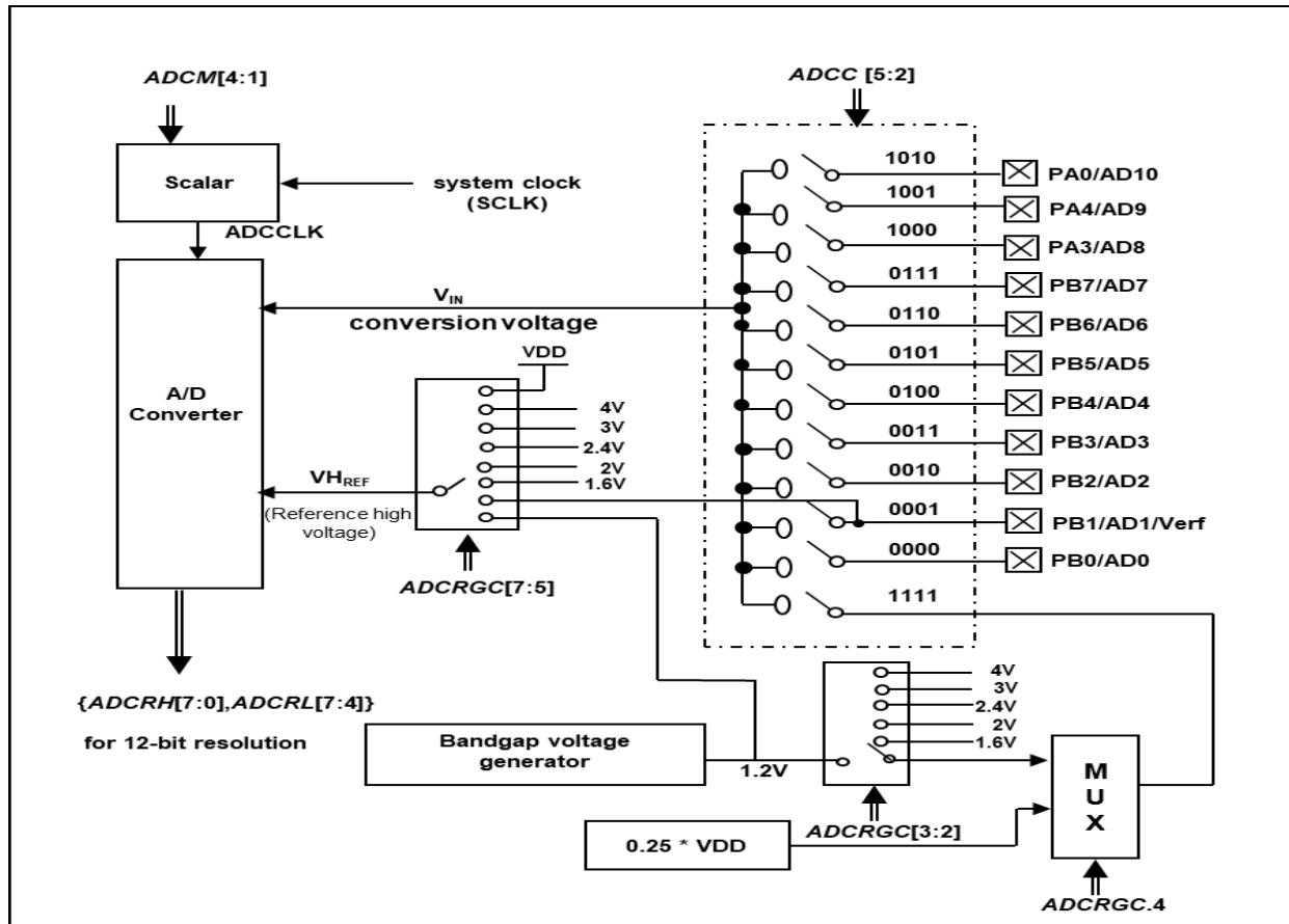
图 19: ADC 模块框图
