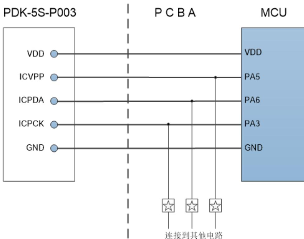
上图为 PFS122B 在板烧录时接线示意图。图中的 ☆ 为电阻或电容，用于隔离烧录引线和其他电路。电阻应  $\geq 10\text{K}\Omega$ ，电容应  $\leq 220\text{pF}$ 。
