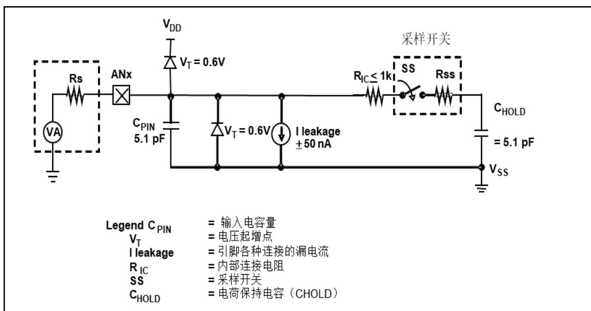
图 20：模拟输入模型
