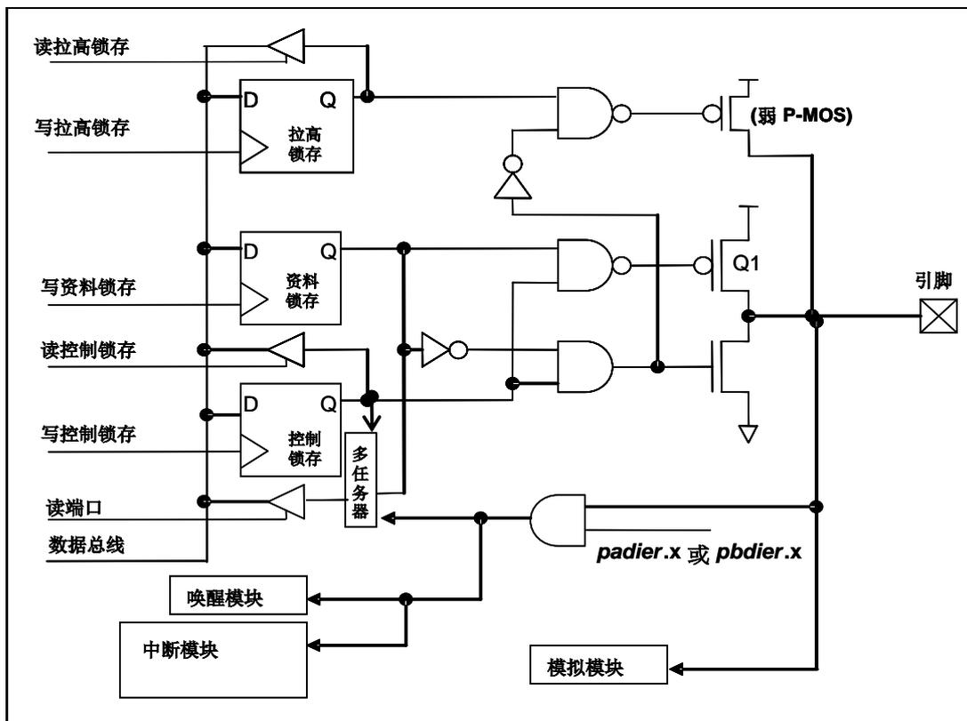
图 6：引脚缓冲区硬件图
