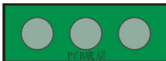
图七、底层按键感应盘正下方不铺铜
