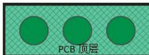
图六、顶层按键感应盘之外铺网格铜
